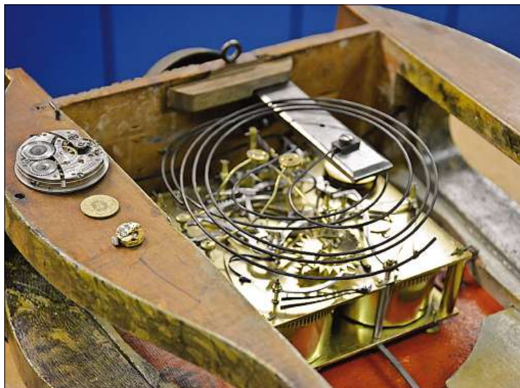
Ein Grössenvergleich: Ein Taschenuhrwerk, das Werk einer Damenarmbanduhr und eine Pendel-Uhr im Vergleich mit einem 5-Rappen-Stück.
